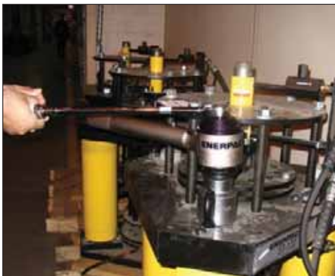
◀ Multiplicador de par con barra de reacción E393 de Enerpac utilizado para apretar manualmente pernos con hasta 3200 pie-lbs (4340 Nm).
